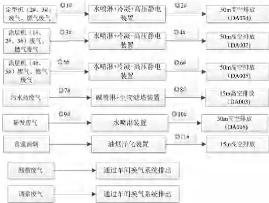
图 4.1-2 废气处理工艺流程及监测点位图 (◎为监测点位)
