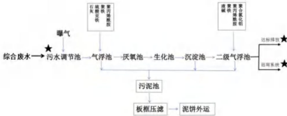
图 4.1-1 水处理工艺流程及监测点位图 (★为监测点位)
