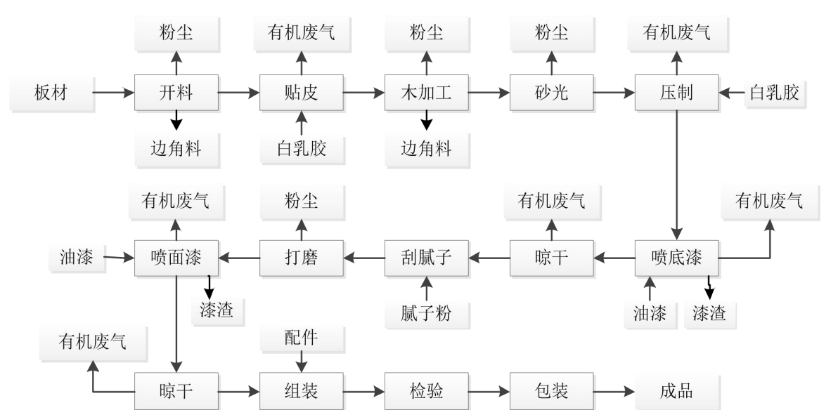
图 2.4-1 办公家具生产工艺流程图及产污环节
