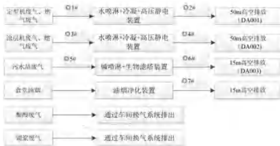
图 4.1-2 废气处理工艺流程及监测点位图（◎为监测点位）
