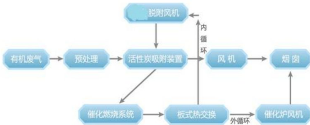
图 4.2-1 活性炭吸附浓缩+催化燃烧工艺流程图
